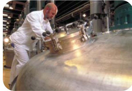
インスリンを生産するイースト菌を大きな 発酵タンクで培養します。(80m 3 )
